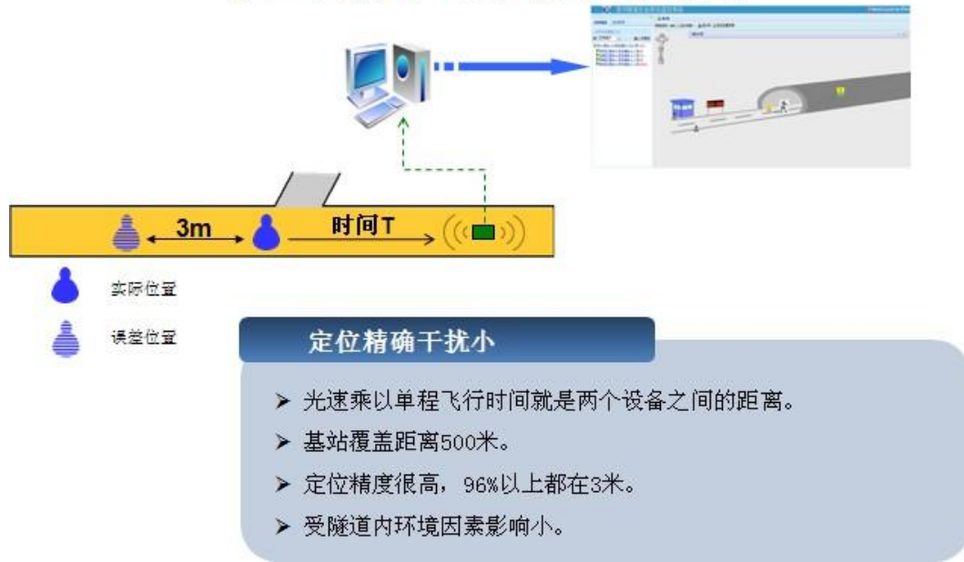
图 1 信号飞行时间技术的定位示意图
